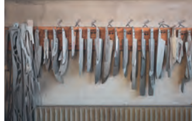
Messerklingen sind hier allgegenwärtig: Diese Rohlinge bilden die Grundlage für das fertige Produkt.
